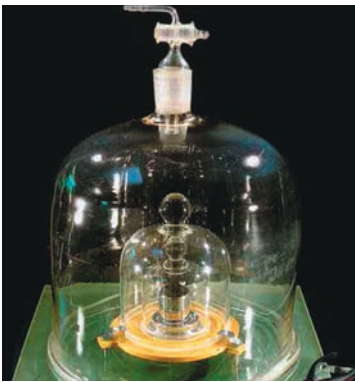
Рис. 17.4. Міжнародний еталон кілограма: a — розміри; б — умо-ви зберігання
