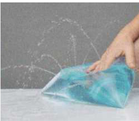
Рис. 26.5. Вода передає додатковий тиск у всі боки і внаслідок цього виходить із пакета в усіх напрямках
