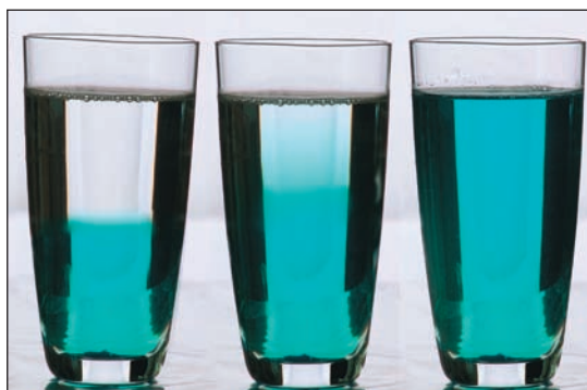
Рис. 2.5. Спостереження явища дифузії в рідинах: у результаті дифузії різка межа між мідним купоросом і водою з часом зникає
