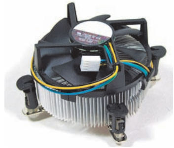
Рис. 13.3. Обертова частота кулерів сучасних процесорів становить 50–60 обертів на секунду
