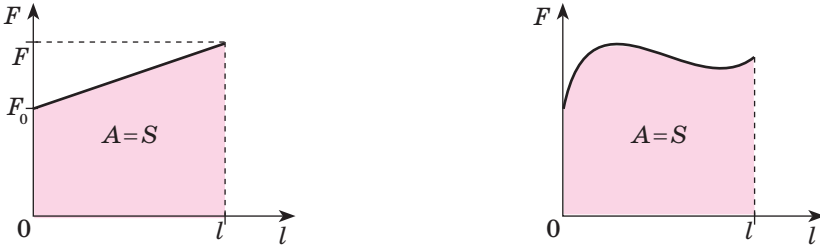
Рис. 34.4. Щоб обчислити роботу A змінної сили F під час руху тіла в напрямку дії цієї сили, слід обчислити площу S фігури під графіком залежності сили від шляху
