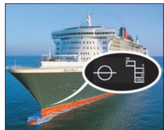
Рис. 33.2. Зазвичай корпус судна пофарбований так, що вище від ватерлінії він чорний або білий, а нижче — відповідно червоний або чорний. Біля самої ватерлінії обов'язково стоять позначки
