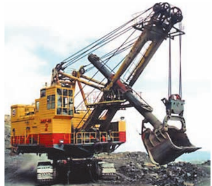
Рис. 40.2. Нерухомі блоки, які є в конструкції кар'єрних екскаваторів, дозволяють змінювати напрямок дії сил під будь-яким кутом
