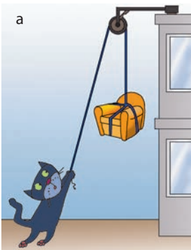
Рис. 40.1. Нерухомий блок можна розглядати як важіль з однаковими плечима. На схемі (б): R — радіус блока; OB — плече сили \vec{F}_1 , що діє з боку тіла; AO — плече сили \vec{F}_2 , з якою на блок діє людина
