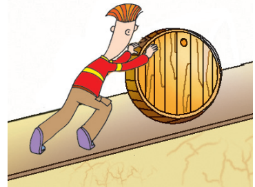
Рис. 41.2. Похила площина є незамінною, коли треба підняти вантаж. Чим пологіший ухил площини, тим легше виконати цю роботу
