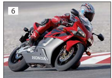
Рис. 20.2. Щоб важкий автомобіль (а) міг розігнатися так само швидко, як легкий мотоцикл (б), на автомобіль слід установити потужніший двигун
