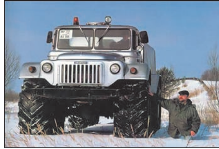
Рис. 25.5. Людина провалилася в сніг, а всюдихід завдяки широким колесам залишився на його поверхні
