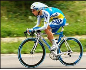
Рис. 21.5. Рама велосипеда зроблена з тонких порожнистих металевих трубок, завдяки чому велосипед є досить легким, залишаючись при цьому міцним
