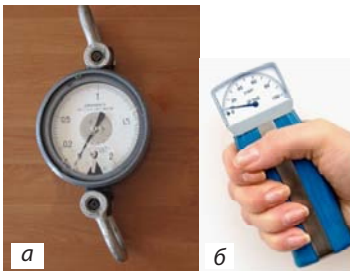
Рис. 22.8. Пружинні динамометри: а — тяговий динамометр, призначений для вимірювання великих сил, наприклад сили тяги трактора; б — динамометр, призначений для вимірювання м'язових зусиль кисті людини
