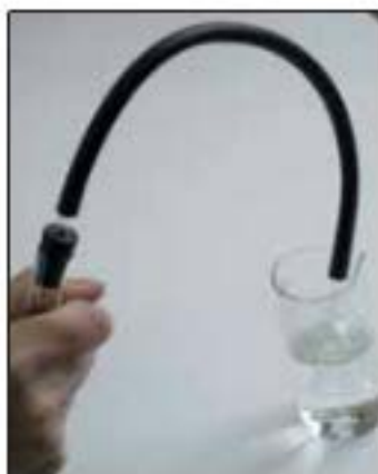
Мал. 59. Перевірка приладу на герметичність
