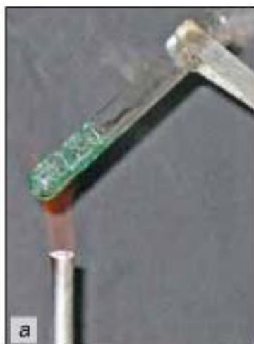
Мал. 20. Нагрівання рідини у пробірці: а — закріпленій у пробіркотримачі; б — закріпленій у штативі
