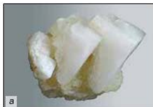
Мал. 28. Кристалічна (а) і аморфна (б) речовини: а — кам'яна сіль; б — скло
