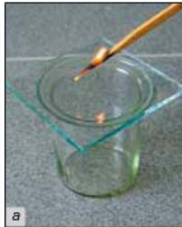
Мал. 53. Виявлення кисню: а — жевріюча скіпка на повітрі; б — спалахування скіпки в кисні
