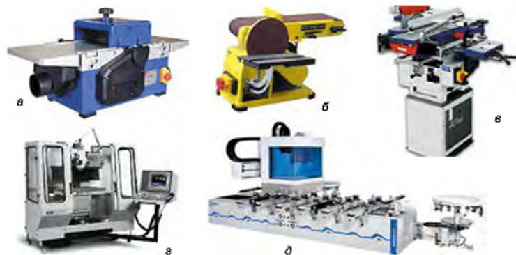
Мал. 174. Деревообробні верстати: а – одноопераційний верстат; б – комбінований верстат; в – універсальний верстат; г – верстат з програмним управлінням; д – обробний центр
