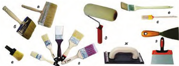
Мал. 211. Малярні інструменти: а – макловиця; б – щітка ролля; е – махова щітка; з – флейцові щітки (лензли); д – валик; е – радіаторна щітка; с – фільонкова щітка; ж – терка шліфувальна; з – шпатель
