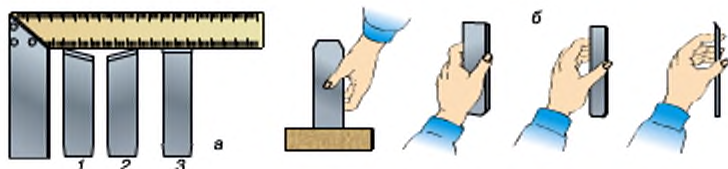
Мал. 90. а – перевірка лева ножа кутником (1–2 – неправильно, 3 – правильно); б – перевірка заточування фаски «на око»
