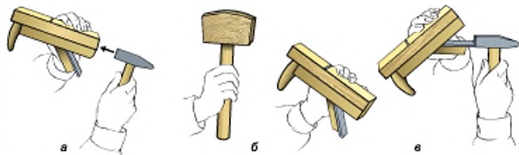
Мал. 92. Регулювання випуску леза: а – зменшення; б – збільшення (перший спосіб); в – збільшення (другий спосіб)
