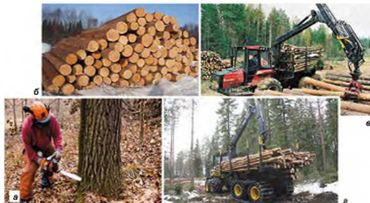
Мал. 9. Заготівка деревини: а – спилювання; б – накопичення хлистів; в – трелювання; г – транспортування
