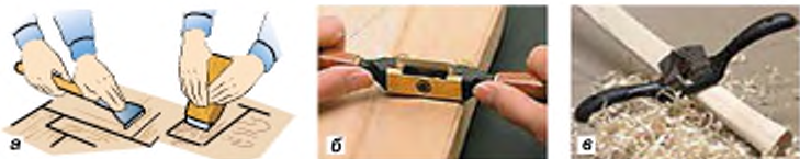
Мал. 84. Прийоми роботи ручними циклями: а – паркетною; б – площинною; в – фігурною
