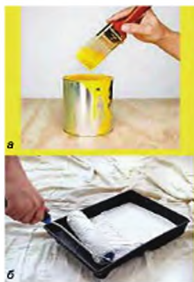
Мал. 223. Підготовка інструментів для нанесення фарби: а – флейцем; б – валиком
