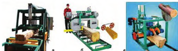
Мал. 10. Лісопильні рамки: а – вертикальна; б – стрічкова горизонтальна; в – дискова
