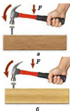
Мал. 22. Забивання цвяха в заготовки з деревини різної твердості: а – тверда порода; б – м'яка порода
