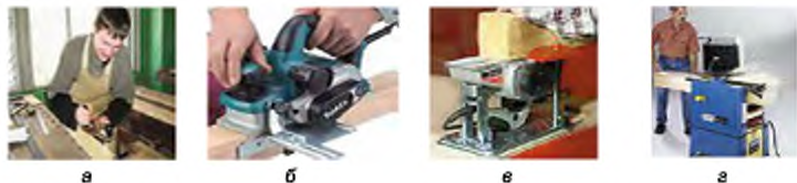
Мал. 76. Способи стругання деревини: а – ручним рубанком; б – електромеханічним побутовим переносним рубанком; в – електромеханічним побутовим стаціонарним рубанком; г – електромеханічним промисловим стаціонарним рубанком
