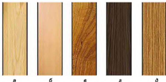
Мал. 25. Зовнішній вигляд деревини: а – ясен; б – бук; в – горіх; г – каштан; д – дуб
