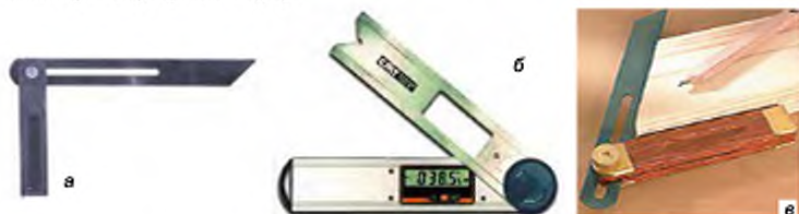
Мал. 51. Малка: а – загальний вигляд; б – сучасна малка з електронним кутоміром; в – використання малки
