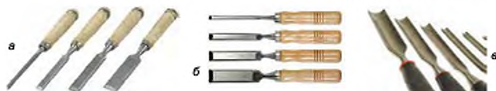
Мал. 110. Набори інструменту: а – долота; б – стамески плоскі; в – стамески напівкруглі
