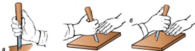
Мал. 149. Виконання різьблення: а – правильна хватка різьака; б – положення різьака під час різання («до себе», «від себе»)
