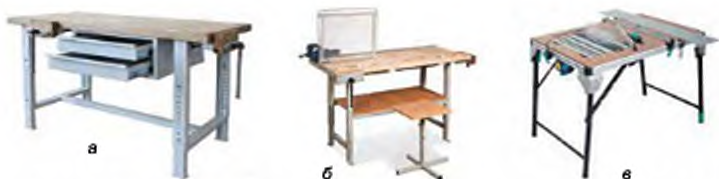
Мал. 4. Столярні верстаки: а – стандартний; б – комбінований; в – універсальний
