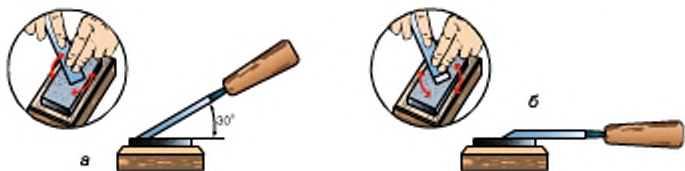
Мал. 111. Загострювання фаски інструмента на брусках
