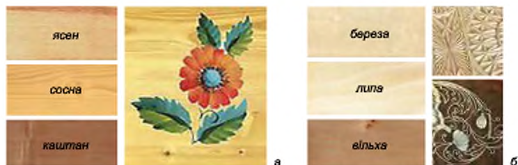
Мал. 137. Залежність текстури та способів оздоблення: а – оздоблення порід з вираженою текстурою; б – оздоблення порід з нечіткою текстурою
