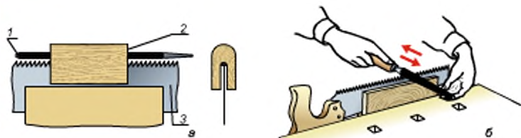
Мал. 67. а – вирівнювання зубів (1 – напилос; 2 – колодка; 3 – полотно ножівки); б – заточування зубів
