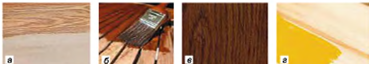
Мал. 136. Фарбування та лакування деревини: а – покриття прозорим лаком; б – покриття тонованим лаком; в – тонування деревини; г – фарбування
