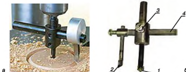
Мал. 126. Розсувний різак: а – свердління одинарним різакком; б – будова (1 – центральне спіральне свердло; 2 – різець; 3 – вимірвальна планка; 4 – кріпильні гвинти)
