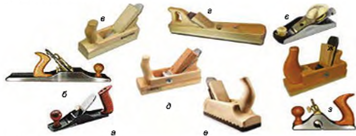
Мал. 78. Інструменти для стругання плоских поверхонь: а – шерхбель металевий, б – напівфуганок металевий, в – рубанок з одинарним ножом; г – фуганок; д – подвійний рубанок, е – шліфтик, е – торцевий рубанок; ж – цинубель; з – рубанок циклювальний
