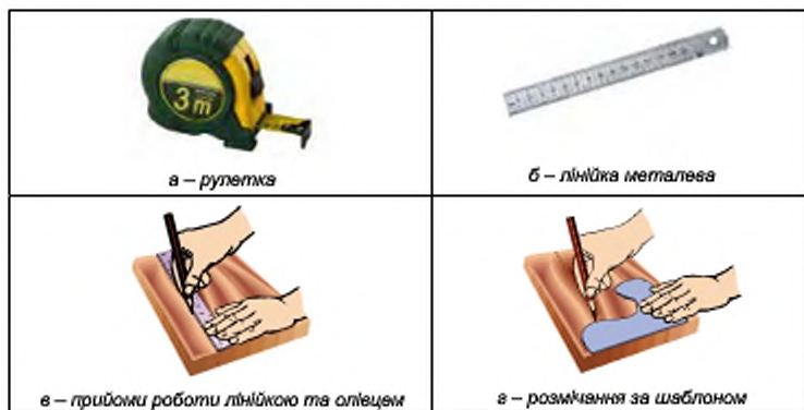
Мал. 47. Деякі розмічальні та вимірювальні інструменти (а, б), прийоми роботи (в, г)
