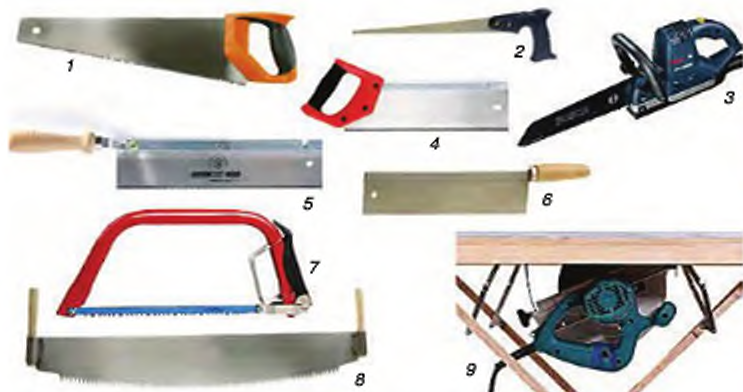
Мал. 61. Види столярних пилок: 1 – ножівка широка; 2 – ножівка вузька; 3 – електрична цепкова пила; 4 – ножівка стуслова; 5 – ножівка з обушком; 6 – наградка; 7 – пила садова; 8 – пила поперечна дворучна; 9 – електрична дискова пила
