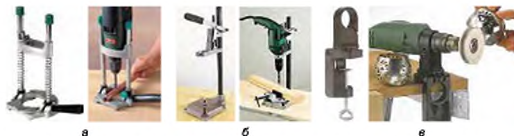
Мал. 169. Технологічні пристосування для електродріля: а – стійка свердлильна; б – свердлильна стійка з колоною; в – утримувач
