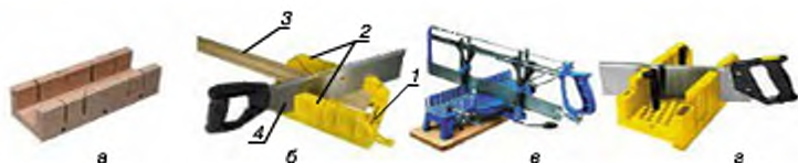
Мал. 72. Види стусел: а – стаціонарне поворотне; б – пластикове; в – дерев'яне; г – із затискним пристроєм
