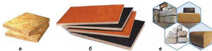
Мал. 13. Конструкційні матеріали: а, б – деревопластичні маси; в – деревні пластики
