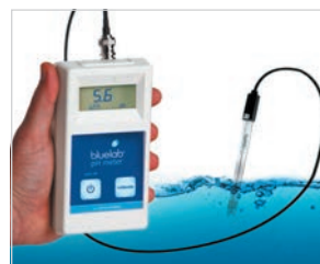
Мал. 11.4. Для вимірювання рН розчинів використовують спеціальні прилади — рН-метри: a — лабораторний (стаціонарний); б — портативний
