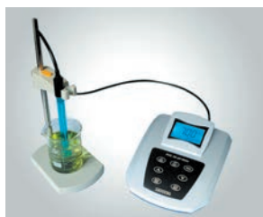
Мал. 11.4. Для вимірювання рН розчинів використовують спеціальні прилади — рН-метри: a — лабораторний (стаціонарний); б — портативний
