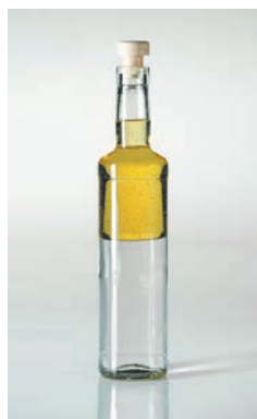
Мал. 6.2. Емульсія олії у воді не стійка: після струшування (а) через певний час рідини розшаровуються (б)
